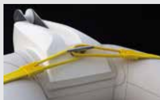
Lasso en composite avec âme métallique
